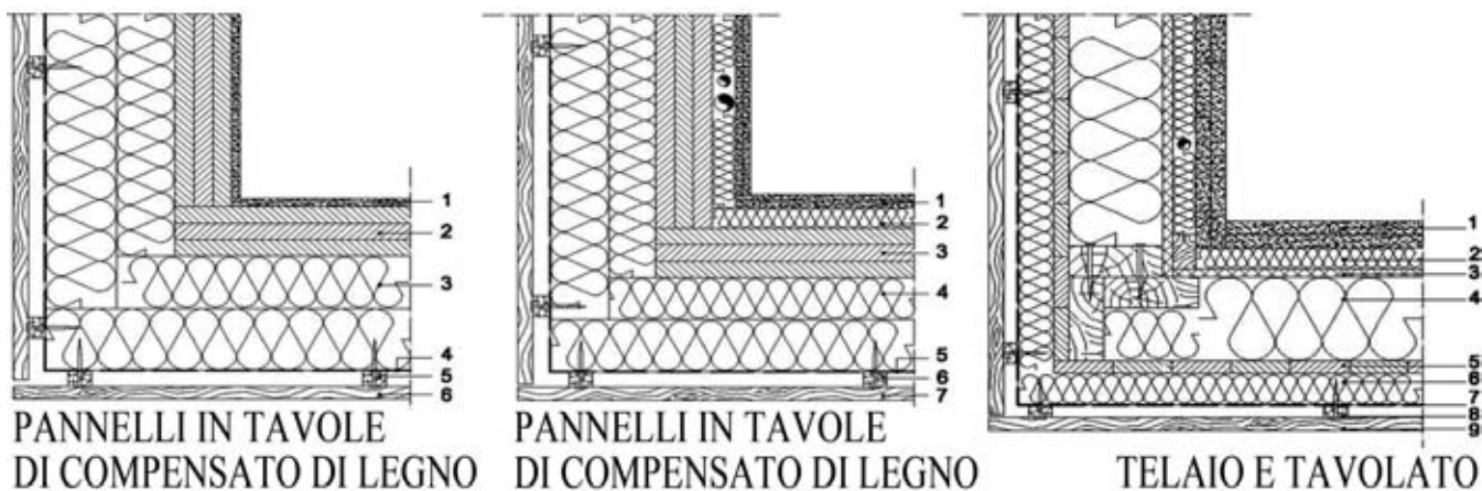
Figura 4. Pareti realizzate secondo i due sistemi costruttivi in legno maggiormente impiegati al giorno d'oggi nel residenziale. Lo spessore raggiunto da tali pareti, per ottenere una trasmittanza di U=15 \text{ W/m}^2\text{K} , è dell'ordine dei 39 cm (Fonte: disegni e foto centrale in basso: autori; immagini: AA.VV., La nuova casa in legno dell'Alto Adige , LVH APA, Bolzano, 2000).
